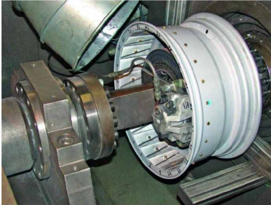
Abb. 5: Eingespannte Felge mit Probeblechen im Schwingmassenprüfstand
