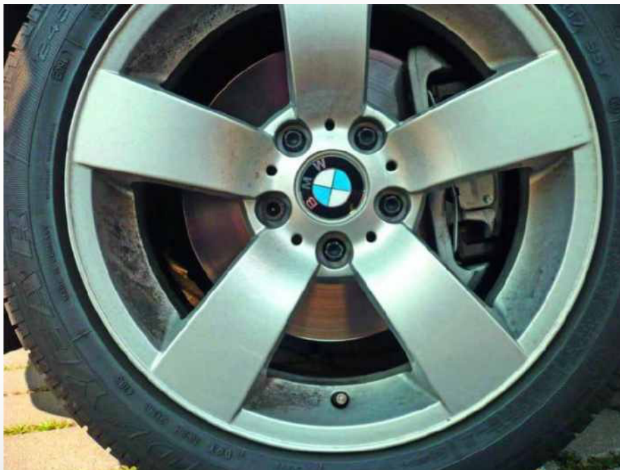
Abb. 6: Polysilazane im Praxistest: Die rechte Seite der Felge, die mit einem Polysilazan-basierten Klarlack beschichtet ist, zeigt eine deutlich reduzierte Bremsstaubanhaftung.
